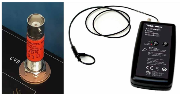
图 x. 探头实例: (a) 电流分流器 (T & M Research SSDN-005, 400 MHz); (b) Rogowski 电流探头 (TRCP0600 电流探头, 30 MHz)。
